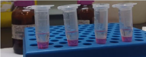
Figura 7: separación de fases obtenida con Tri Reagent ®. La fase inferior, coloreada, contiene proteínas. El ARN extraído es retenido en la fase acuosa superior. El ADN permanece en la interfase.
