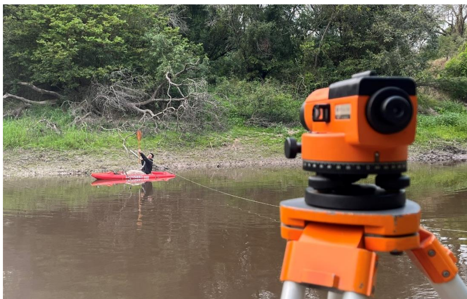
Imagen II. 6. Proceso de toma de lecturas con nivel óptico.
