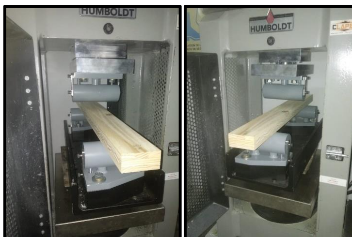
Figura 36: Prensa de carga Humboldt, con equipo para ensayos a flexión, UNNE (Fuente: Elaboración Propia).
