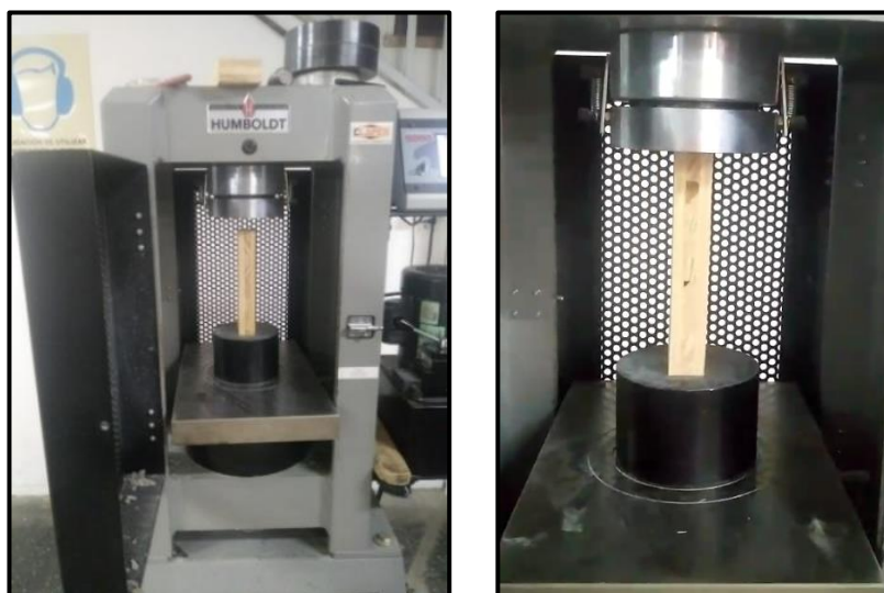
Figura 35: Prensa de carga Humboldt, UNNE (Fuente: Elaboración Propia).
