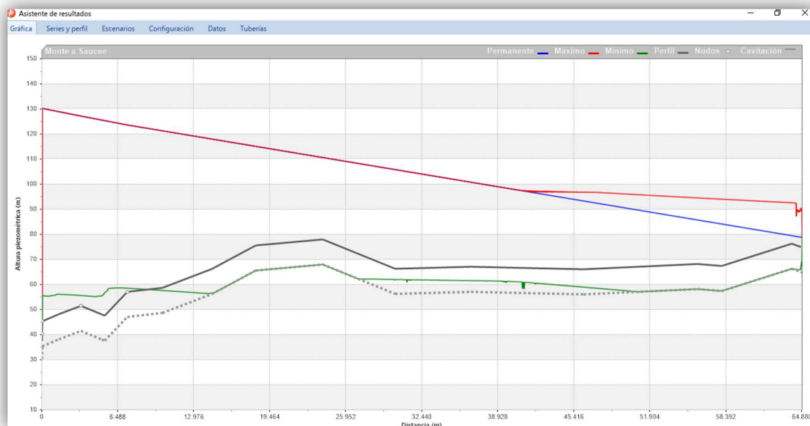
Ilustración 47. Resultado envolvente de presiones tramo 2 (Fuente: elaboración propia en programa Allievi).
