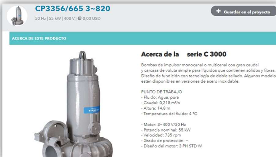
Ilustración 38. Bomba seleccionada para el año 20 (Fuente: Xylect, año 2024).
