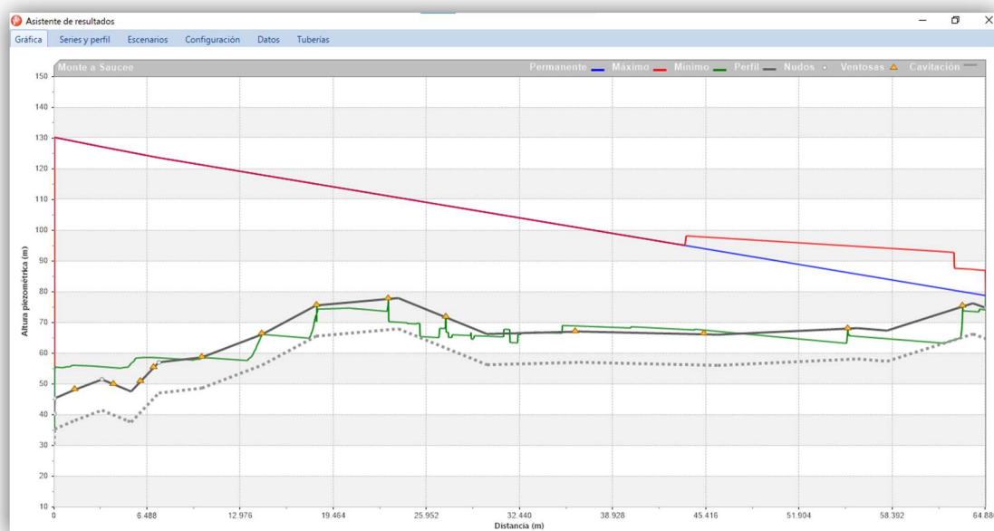
Ilustración 50. Resultados Alturas piezométricas con válvulas de aire, tramo 2 (Fuente: elaboración propia en programa Allievi)
