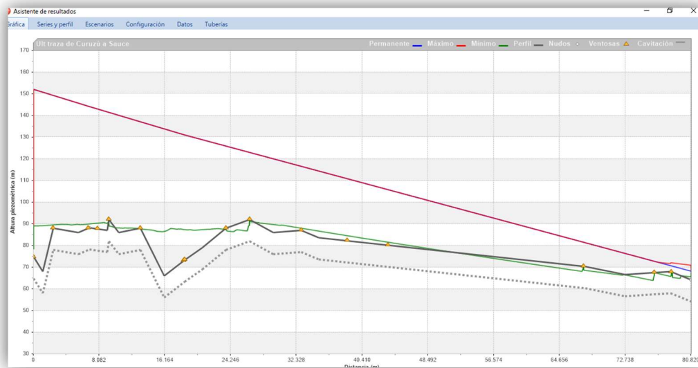
Ilustración 56. Resultado de la envolvente de presiones con válvulas de aire, tramo 3 (Fuente: Programa Allievi)
