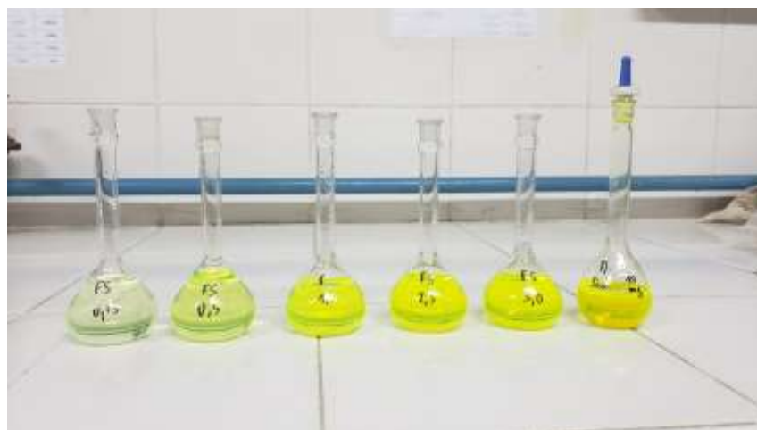
Figura N°47: Preparación de la curva patrón con diferentes concentraciones de fluoresceína sódica.
