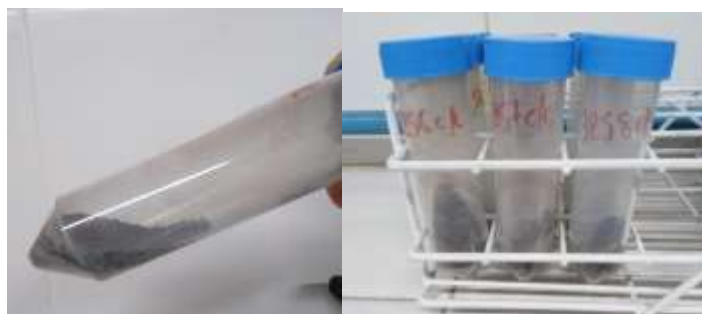
Figura N°25: Tubos con suelos humedecidos en forma de pico de flauta y colocados en la gradilla para llevar a incubar.
