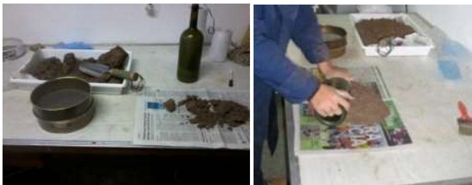
Figura N°6 y 7: Proceso de molido y tamizado de las muestras.
