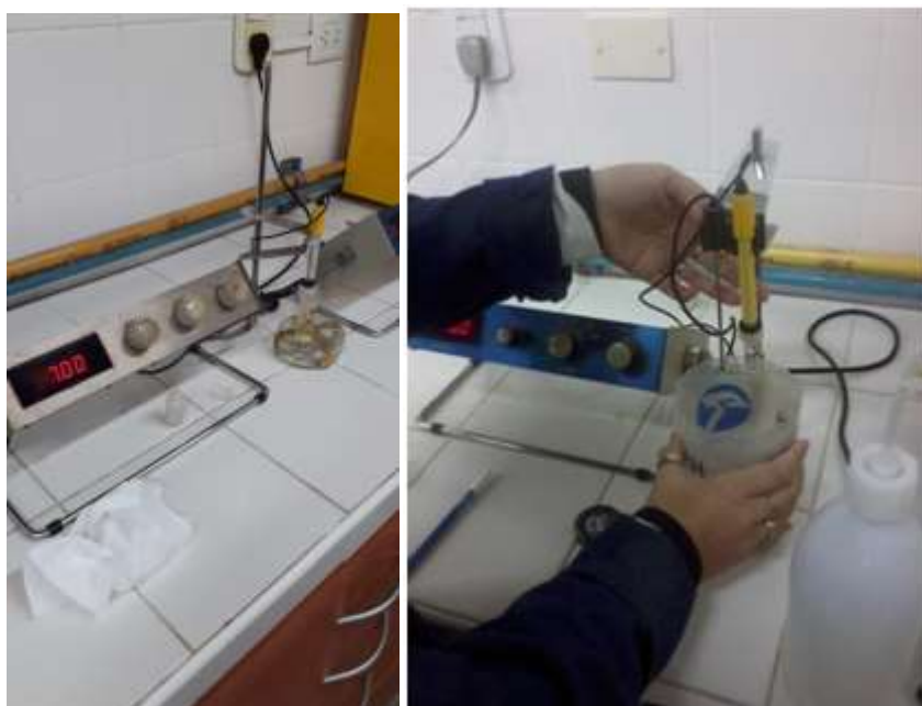
Figura N°8 y 9: Calibración y Lectura de pH
