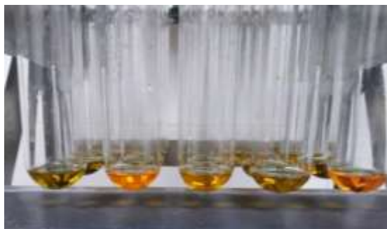
Figura N°31: Extracto luego de la digestión. Se observa distintas coloraciones según el contenido de Biomasa microbiana.
