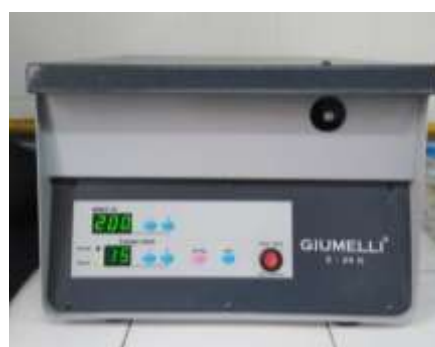
Figura N°27: Centrifugado a 2000 r.p.m. por 15 minutos
