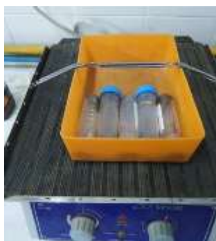
Figura N°26: Agitación de los tubos en forma horizontal
