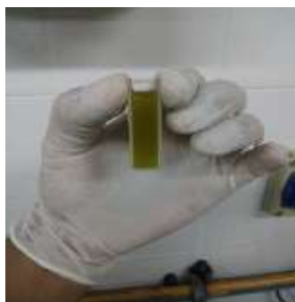
Figura N°32: Celda del espectrofotómetro con el extracto a medir.
