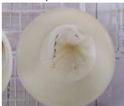
Figura N°28: Filtrado de la muestra con filtro banda azul
