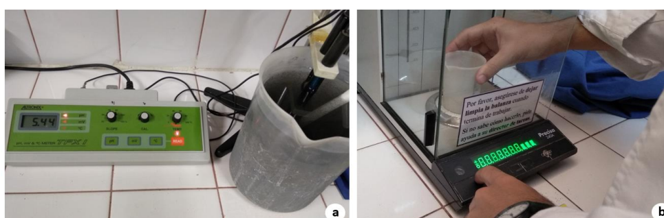
Figura 1: Preparación del medio de cultivo. Referencias: a: medición del pH; b: pesaje del agente gelificante (agar Sigma® A1296).
