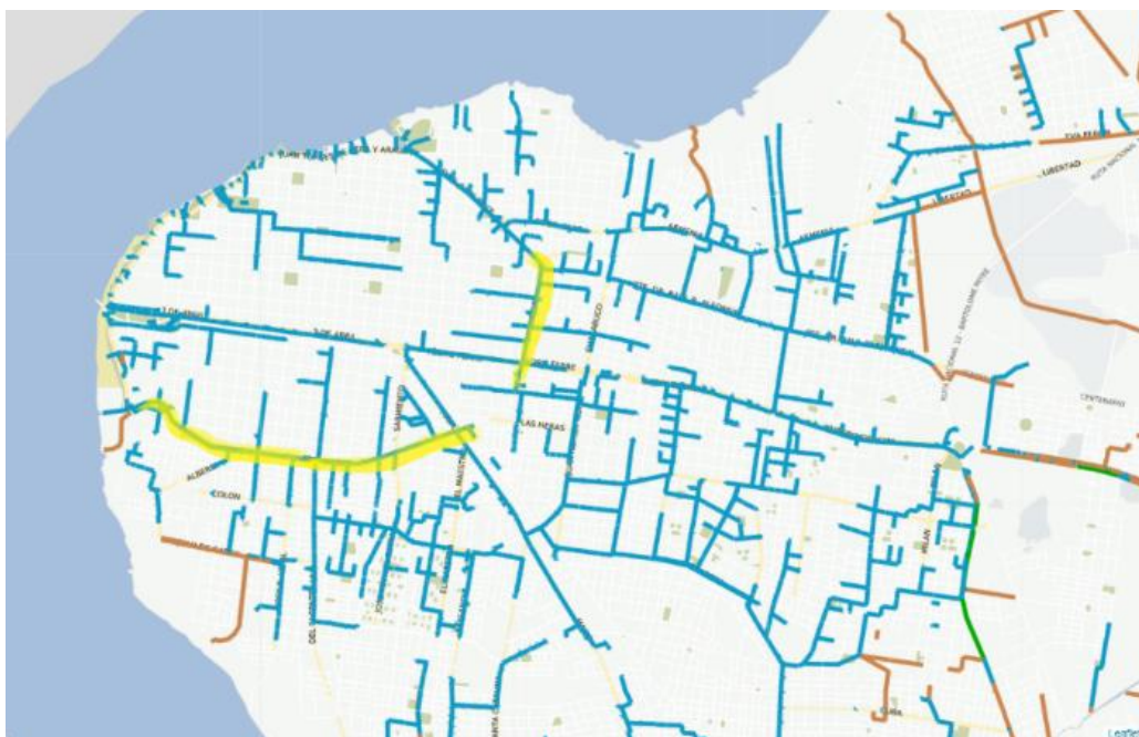
Figura 29. Entubamiento actual de desagüe de la ciudad de Corrientes. Base de dato digital de la Municipalidad, elaboración propia, resaltado en color amarillo, el recorrido del arroyo Limita.
