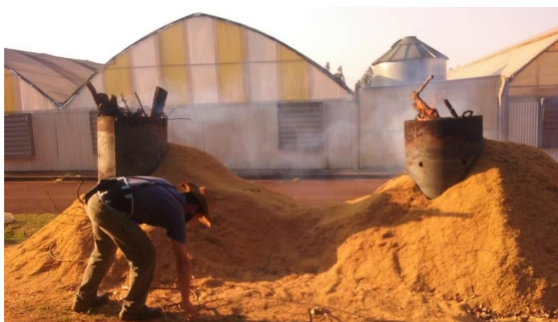
Fig. 7. Montículos de cascarilla de arroz cruda en proceso de carbonización.
