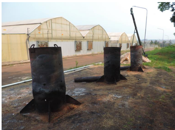
Fig. 6. Producción de cascarilla de arroz carbonizada.
