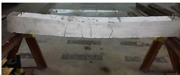
Figura 9: Viga 2. Patrón de fisuras y modo de rotura.
