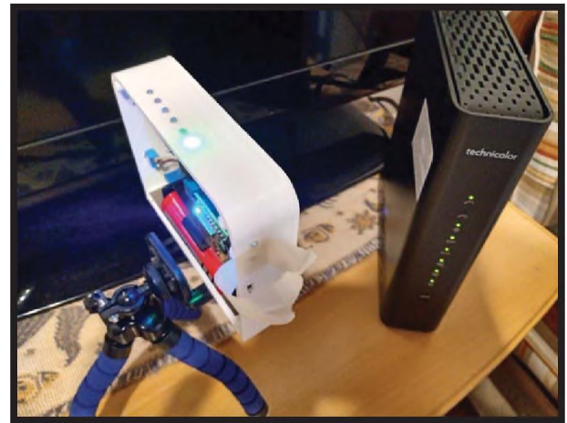
Figura 13. Ensayo básico de funcionamiento del monitor personal con Router WiFi.
