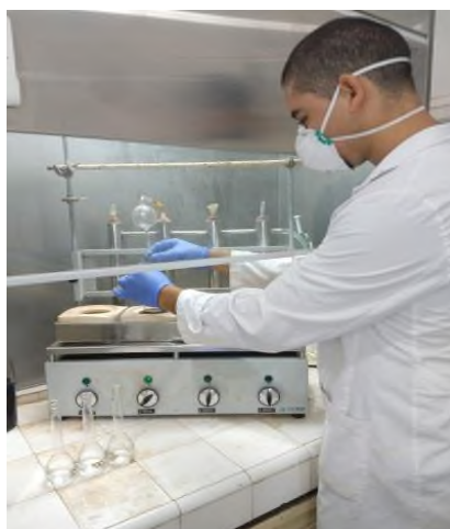
Foto N° 5. Proceso de destilación, método Kjeldahl.
