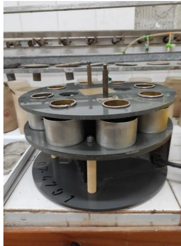
Figura nº 1: Maquina para realizar estabilidad de agregados con tamizado en húmedo según el método de Kemper & Rosenau,
