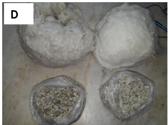
Figura 17. Desmote de las muestras de algodón en bruto. A) Vista de la micro-desmotadora de ensayos; B) Semillas en la bandeja colectora; C) fibra en el depósito o canasto, y C) Muestras terminadas para realizar el nuevo pesaje de las fracciones.
