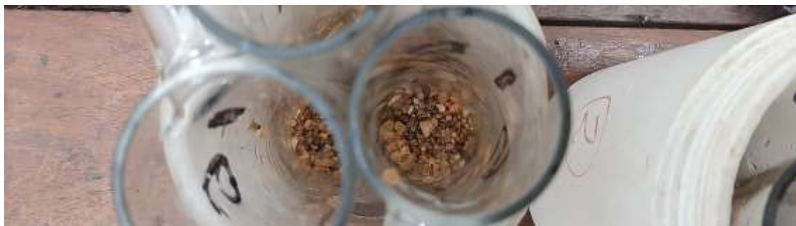
Foto 4. Percolador de vidrio, con base cargada de gravilla.
