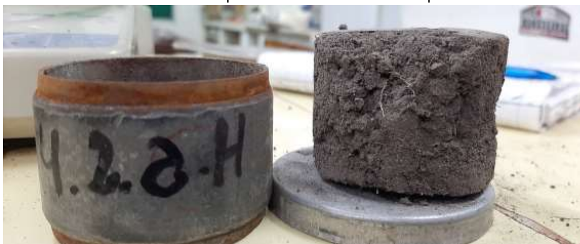
Foto 9. Muestra inalterada. Densidad aparente, pesaje de muestra.
