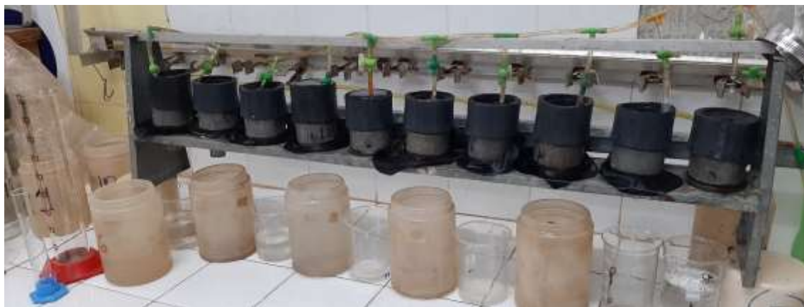
Foto 6. Percoladores para la determinación de Conductividad hidráulica a flujo saturado en muestras inalteradas.
