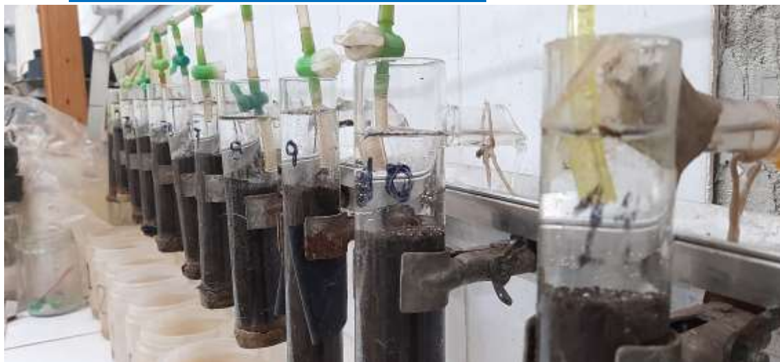
Foto 10. Equipo de percoladores de vidrio, montados a sus soportes, para la determinación de la Conductividad hidráulica a flujo saturado ( K_w ) en muestras de suelos alterados.
