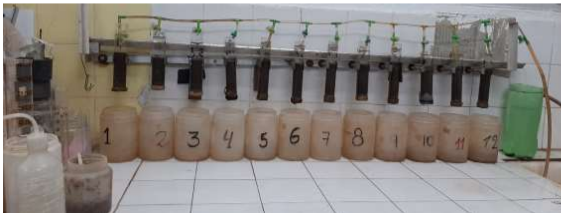
Foto 5. Percoladores para la determinación de Conductividad hidráulica a flujo saturado en muestras alteradas.
