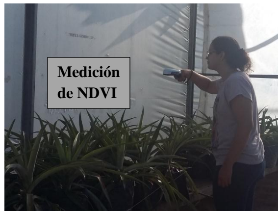
Figura 2: Medición de NDVI con el equipo Trimble® GreenSeeker Handheld Crop Sensor.
