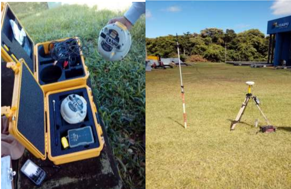
Imagen 2: Levantamiento topográfico con el Aparato GNSS.
