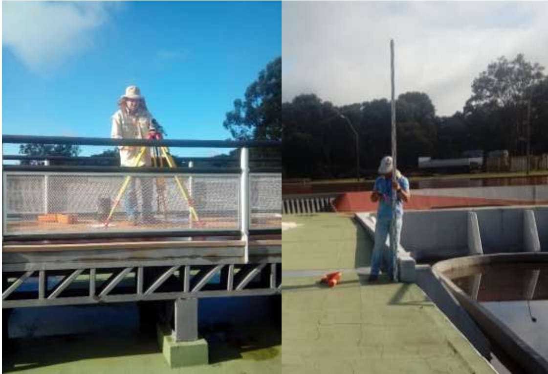
Imagen 3: Levantamiento topográfico con el aparato nivel topográfico y la mira topográfica.
