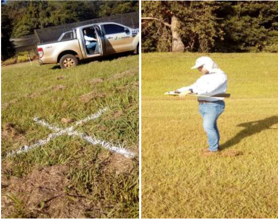
Imagen 1: Marcación de los puntos de control y Lanzamiento del dron
