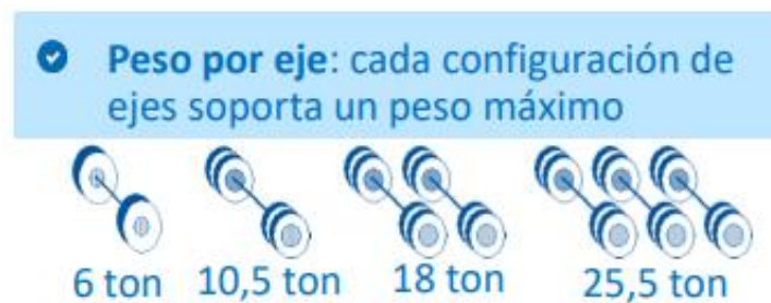
Figura 5.7. Peso máximo según el tipo de eje (Fuente: https://www.argentina.gob.ar/sites/default/files/dnptcy_l_nuevos_vehiculos_modificaciones_normativas_may_2019.pdf ).
