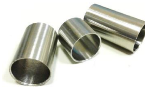
Figura 9. Acoples sin costura fabricados por el grupo de trabajo mediante extrusión por punzonado en caliente [33].
