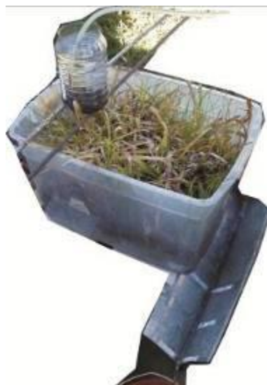
Figura 5.- Ensayo en modelo físico: dispositivo simulador de lluvia (parte superior); canaleta y recipiente receptor (parte inferior).
