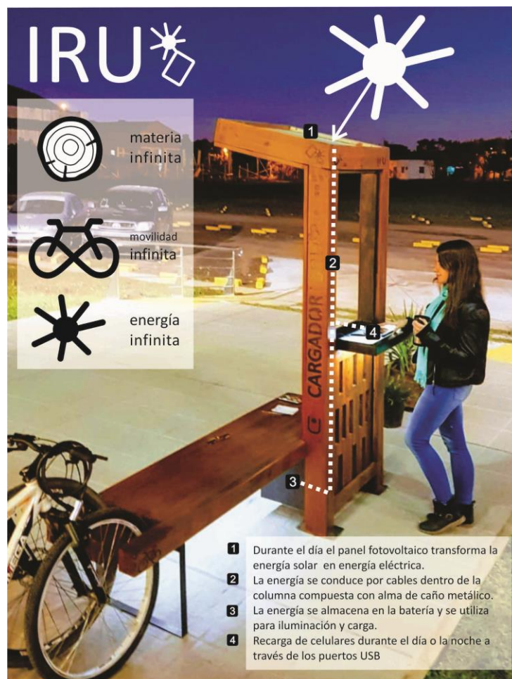
Figura 1: IRU Cargador Solar Multipropósito. Explicación gráfica del funcionamiento del sistema solar fotovoltaico autónomo (SFA) y aspectos ambientales más destacados. Fuente: elaboración propia.
