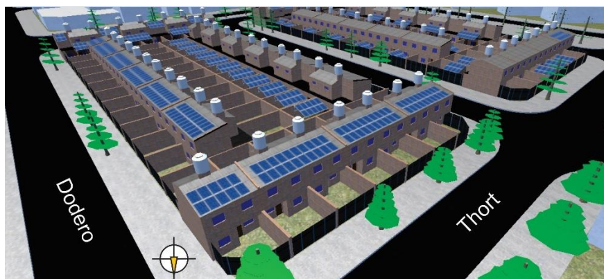
Figura 4 - Propuesta de intervención con SFCR del B° MUPUNNE. Fuente: elaboración propia en base a modelación del programa PV*SOL premium 2019.
