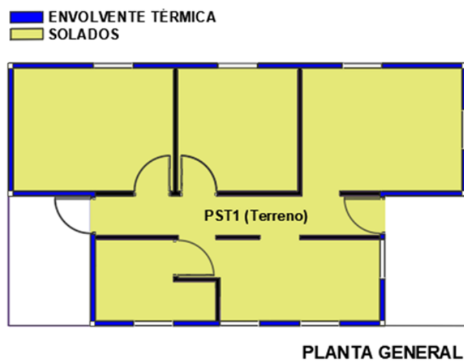
Figura 6: Identificación de los elementos de la envolvente térmica. SOLADOS. Fuente: Morán, 2022.
