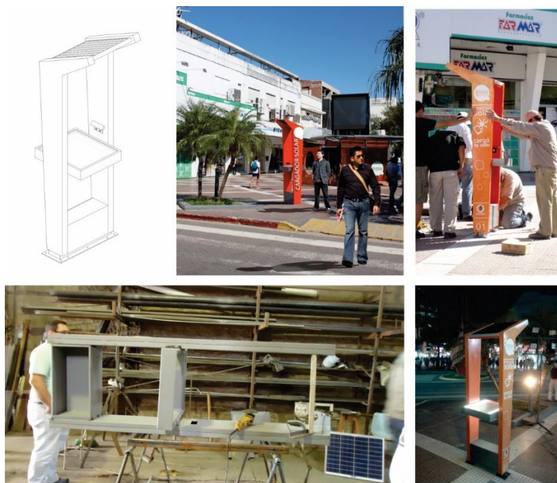
Figura 1 – Proceso de diseño del cargador en metal. Se observa axonométrica, fotomontaje, fabricación, montaje y puesta en funcionamiento. Fuente: elaboración propia.
