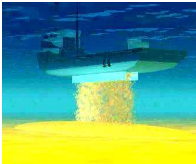
Figura 10: Dragado para condiciones de disposición del material en forma controlada (embarcaciones con cántaras)
