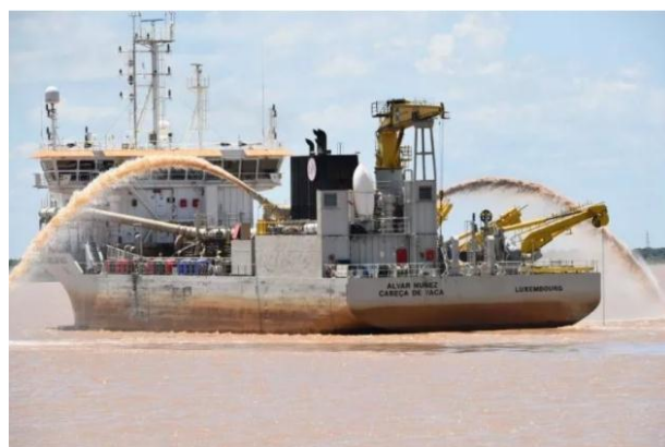
Figura 9: Dragado para condiciones de libre disposición del material utilizada en la Hidrovía Paraná - Paraguay
