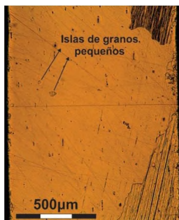
Figura 12. Islas de granos pequeños dentro de la microestructura tipo bamboo. Diámetro del alambre: 1.4mm; TZC: 750°C; velocidad de arrastre: 9.5µm/seg.
