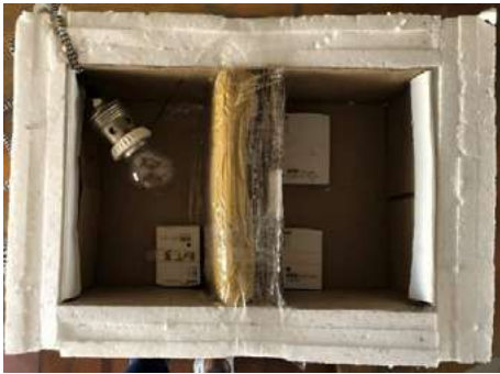
Fig. 5: Imagen del recinto adiabático con los sensores de temperatura. | Fuente: Elaboración propia.
