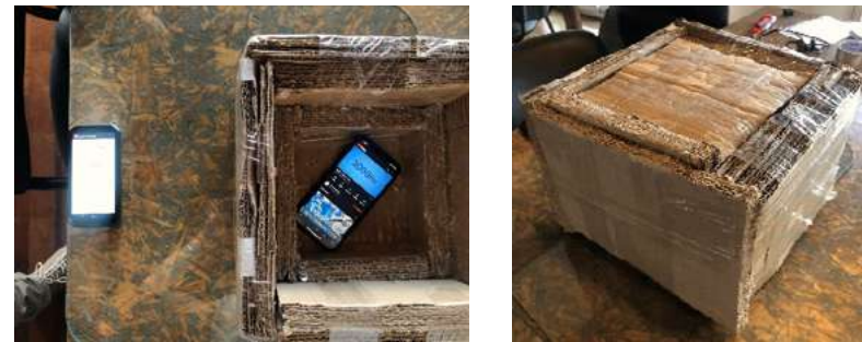
Fig. 7: Ensayo acústico con cubo de cartón mediante. | Fuente: Elaboración propia.
