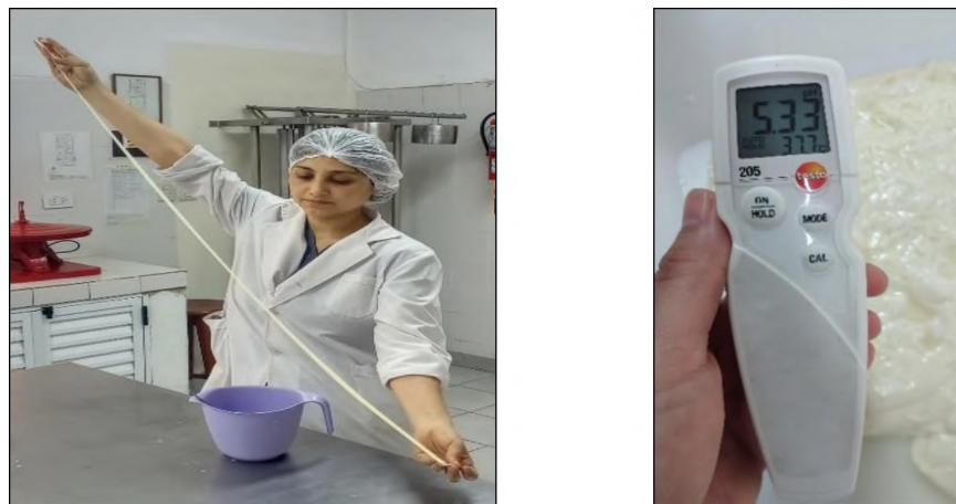
Fig. 14 Prueba de estiramiento(izq.) medición de pH óptimo de pasta(der.).
