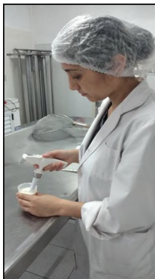
Fig. 4 medición de pH y temperatura de materia prima.
