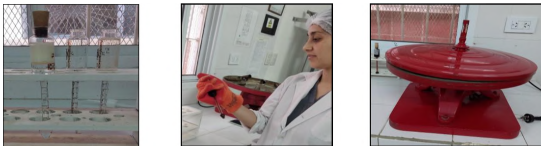
Fig.7 butirometro cargado(izq.)-combustión de compuestos(cen.) -centrifuga(der.).
