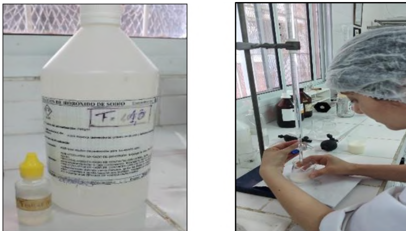
Fig. 8 solución de fenolftaleína, solución de NaOH(izq.) titulación gota a gota(der.).
