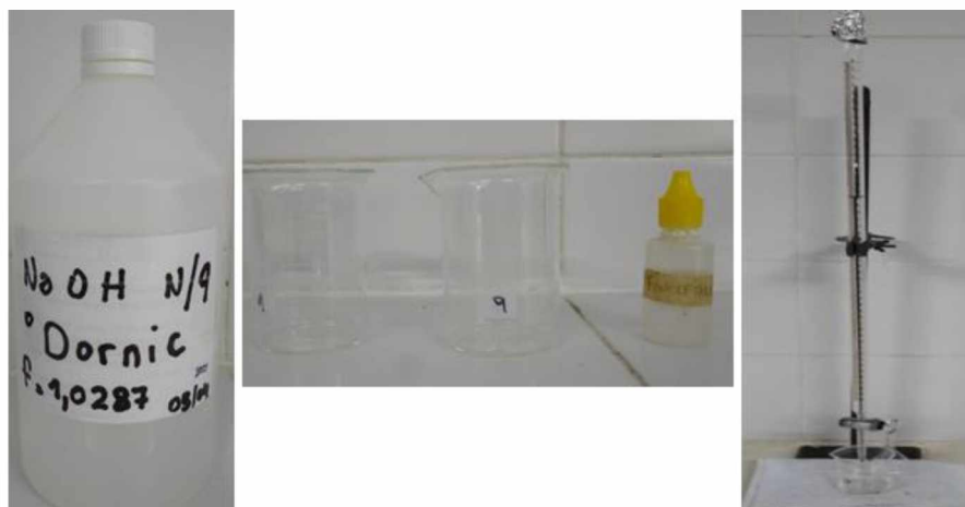
Foto N° 5: Hidróxido de Sodio N9/9 (izq), vaso de precipitado de 100 ml y solución alcohólica de fenolftaleína al 1% en frasco gotero(cen) y bureta dividida en 30 décimas de ml (der)
