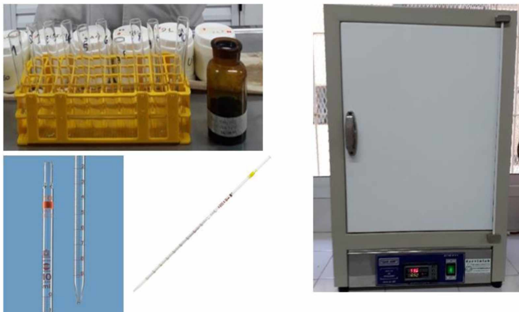
Foto N° 6: Pipeta de 10ml y 1ml. Tubos en gradillas y azul de metileno 1x40 (der) y estufa (izq).
