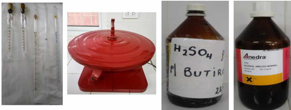
Foto N° 3: Butirómetros, pipetas y centrifuga (izq.), Ácido Sulfúrico y alcohol amílico (der.)
