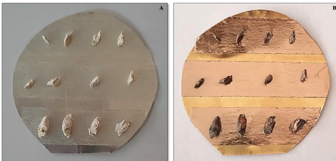
Fig. 7: A) Montaje de las muestras y secado a punto crítico y B) Metalización con oro paladio.
