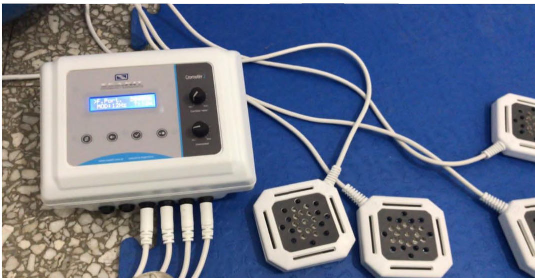
Figura 5. Equipo de fototerapia Cromoter II. Provisto de 4 aplicadores pocket cada uno con 12 diodos infrarrojos (904nm) 8 diodos rojos (670nm) 5 diodos amarillos (590nm). Imagen cedida por M.V. Ramírez, Rocío L.
