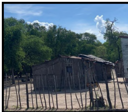
Figura 5: vivienda construida con madera y barro.
