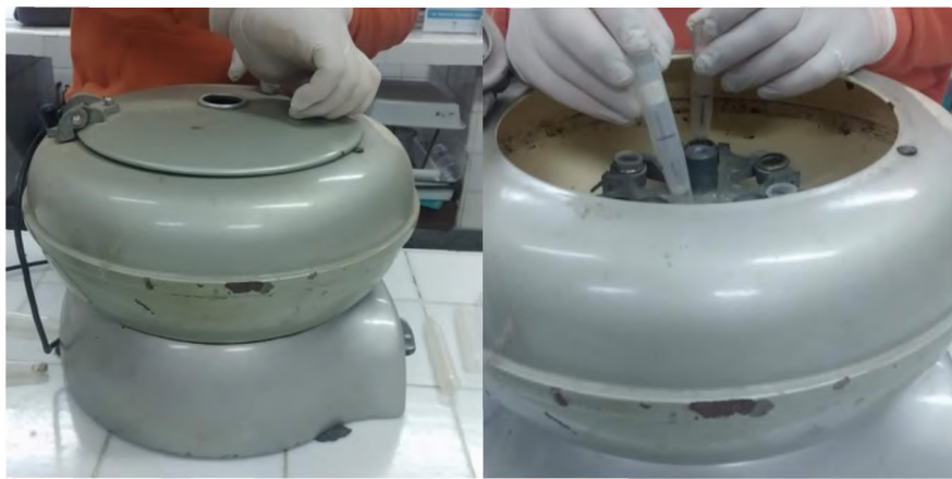
Imagen N°4: Tubos capilares en centrifuga. Imagen N°5: Centrifugado a 15.000 rpm durante 5 minutos
