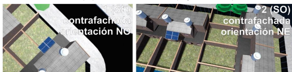
Fig. 94: Propuesta de optimización para viviendas en los frentes más desfavorables (1 kWp). Fuente: Elaboración propia en base al programa PV*SOL Premium 2019.
