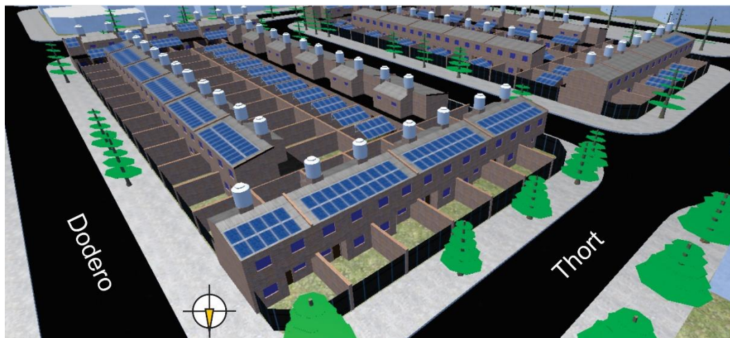
Fig. 91: Propuesta de intervención con SFCR del B° MUPUNNE desde el Norte, manzana 74. Fuente: elaboración propia en base a modelación del programa PV*SOL premium 2019.
