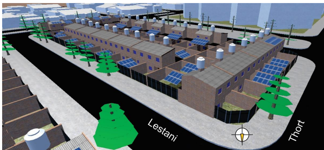
Fig. 92: Propuesta de intervención con SFCR del B° MUPUNNE desde el Norte, manzana 75. Fuente: elaboración propia en base a modelación del programa PV*SOL premium 2019.
