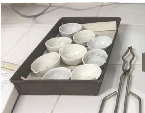
Foto N°27: muestras post mufla (izq.), pesado de crisol con muestra post mufla (der.).
