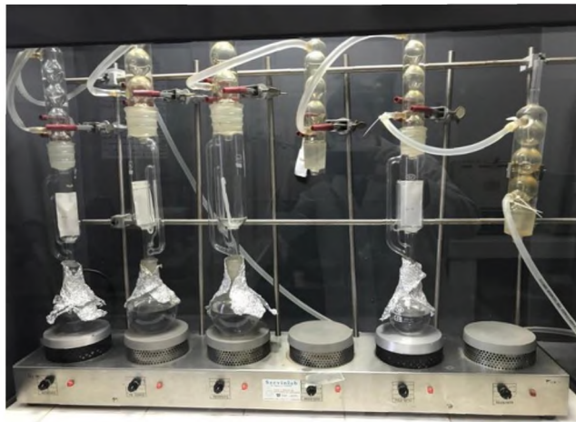
Foto N°24: pesado de la muestra en balanza de precisión(izq.), extractor de Soxhlet armado(der.).
