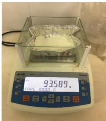
Foto N°20: muestra de yogurt fresca pesada en balanza de precisión (izq.), muestra de yogurt luego de 48 hs en estufa(der.).
