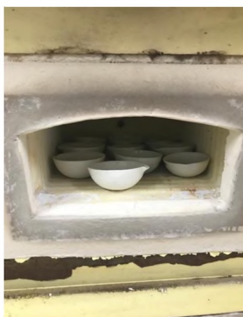
Foto N°26: pesado en balanza analítica de crisol vacío (izq.), pesado de crisol con Ig de muestra (der.), mufla con crisoles (der.).
