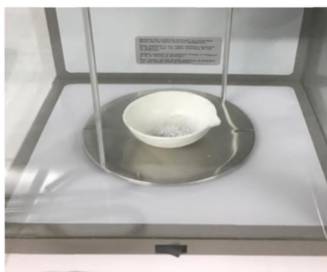
Foto N°27: muestras post mufla (izq.), pesado de crisol con muestra post mufla (der.).
