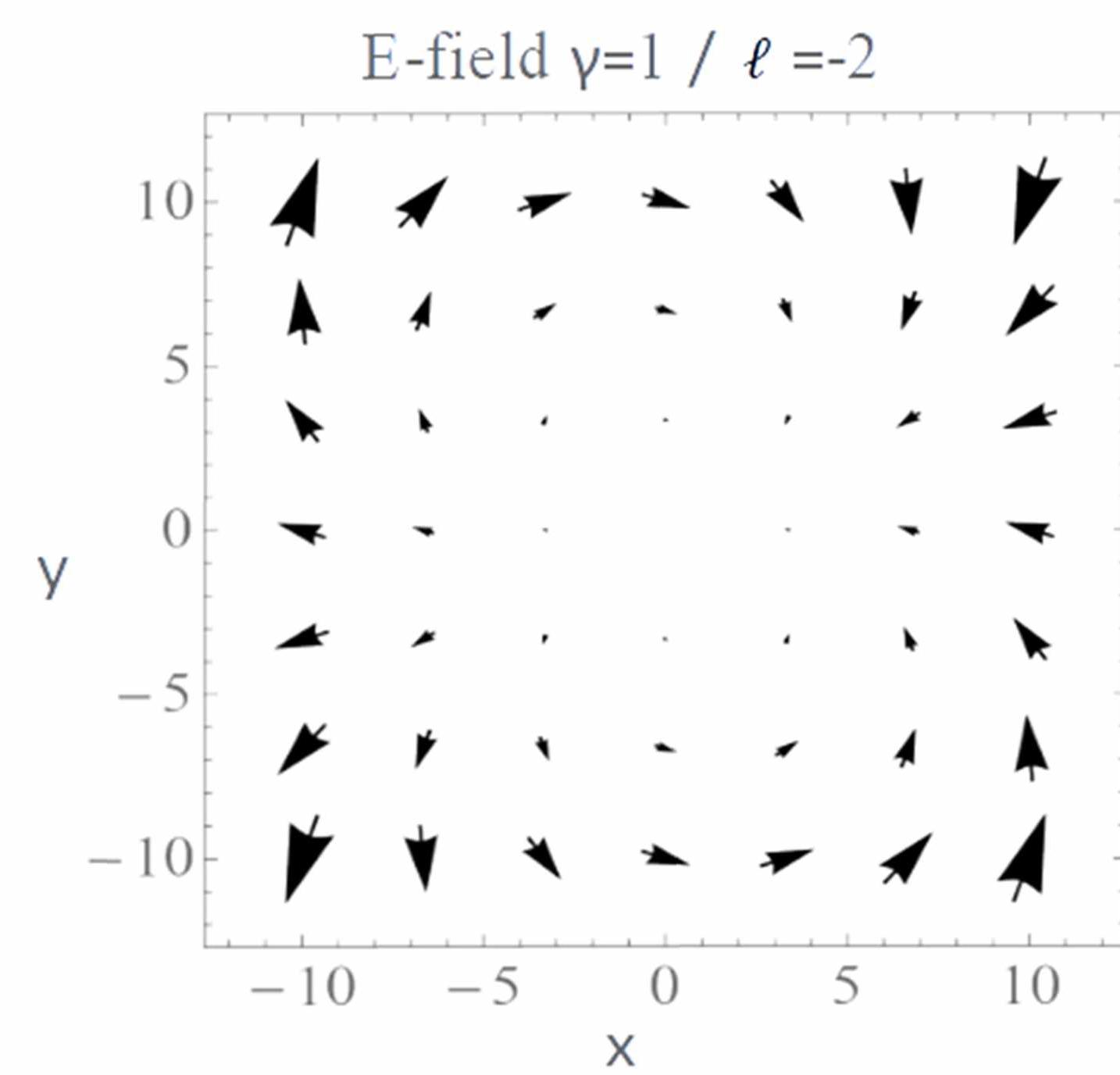
Para  $\sigma = +1$  y  $\ell = -2$  el campo magnético es constante y el campo eléctrico tiende a cero cerca de  $r = 0$ . (Caso  $\gamma = 1$ , suma de tres ondas planas).
