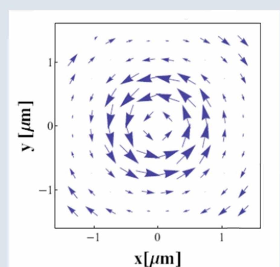
Componente transversal del vector de campo eléctrico en un OV.
