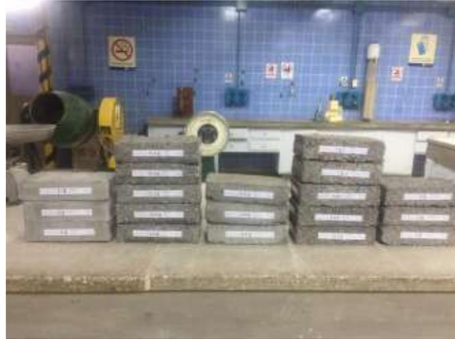
*Figura 27. Ladrillos con distintas Dosificaciones Listos para Encabezar*
