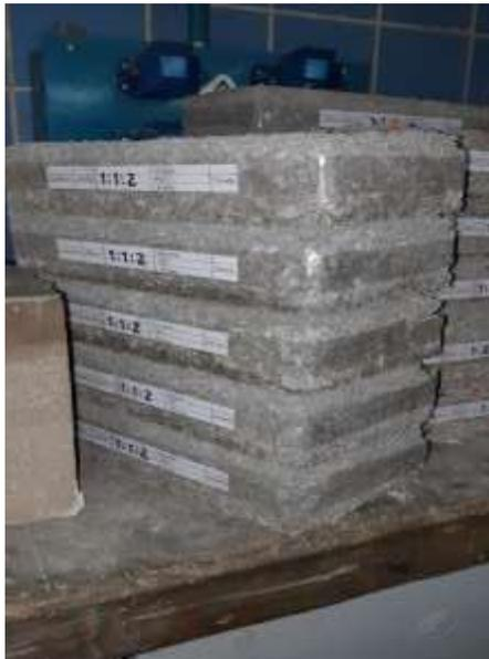
*Figura 25. ECO Ladrillos Identificados para Encabezarlos*
