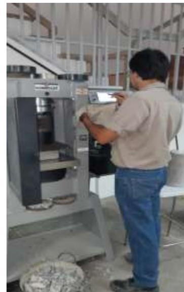
*Figura 26. Calibrando Nueva Maq. de Ensayos*
