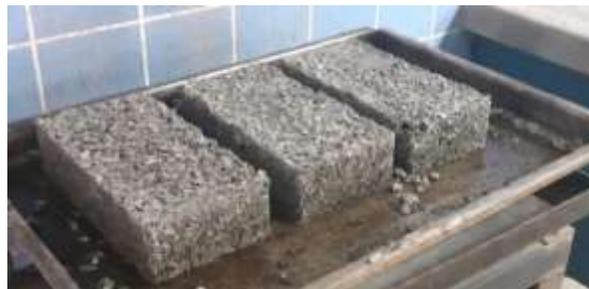
*Figura 11.* ECO Ladrillo desmoldado
