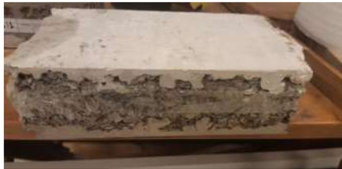
*Figura 12* Encabezado de un ECO Ladrillo
