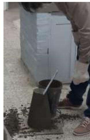
*Figura 22. Verificación del Cono de Abrams*
