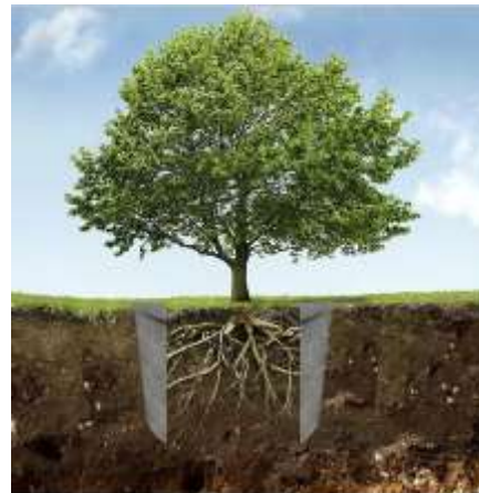
Figura 39. Ubicación tubo de hormigón como barrera de raíces (fuente: elaboración propia).
