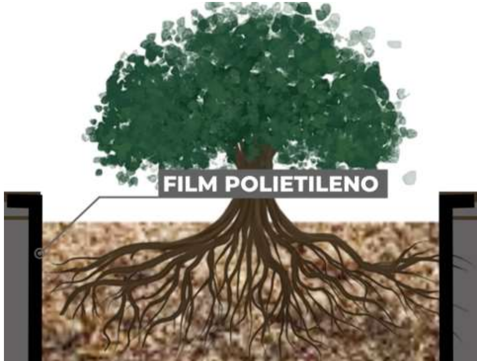
Figura 38. Ubicación geomembrana de polietileno como barrera de raíces (fuente: Arq. Marcelo Seia).
