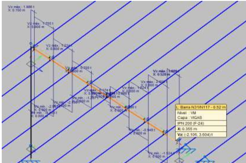
Figura 50. Corte máximo en la viga (elaboración propia) V_c : Resistencia de diseño a cortante
