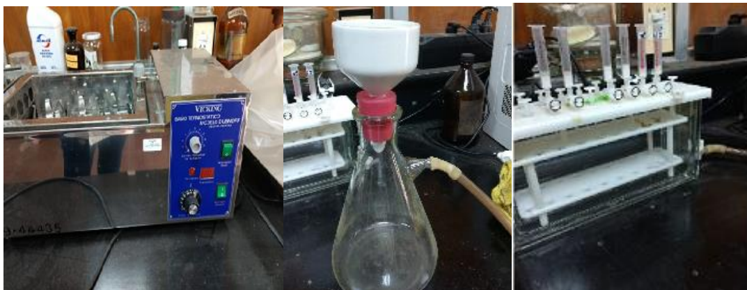
Figura 2.8. Baño termostático con agitación; equipo de filtración al vacío; y cartuchos SPE con Manifold.
