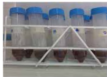
Figura N° 5. Tubos Falcon con suelo y citrato de sodio luego de un ciclo de autoclavado.
