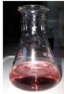
Figura N° 4. Cambio de coloración al titular el extracto destilado con H 2 SO 4 0,01 N.
