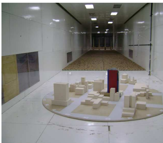
Fig. 3. Modelo del edificio mostrando la reproducción del entorno inmediato en la cámara de ensayos del túnel de viento.
