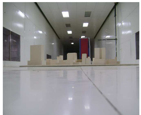
Fig. 3. Modelo del edificio mostrando la reproducción del entorno inmediato en la cámara de ensayos del túnel de viento.
