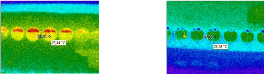
Figura 7: Imagen térmica con valor obtenido de temperatura del aire – abertura superior e inferior.
