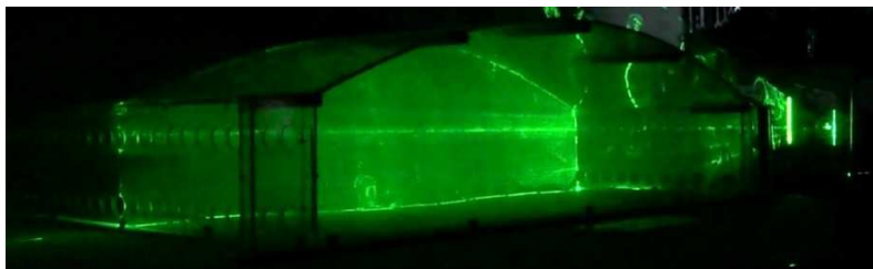
Figura 3: Vista del plano de medición con la presencia de humo trazador durante el ensayo.
