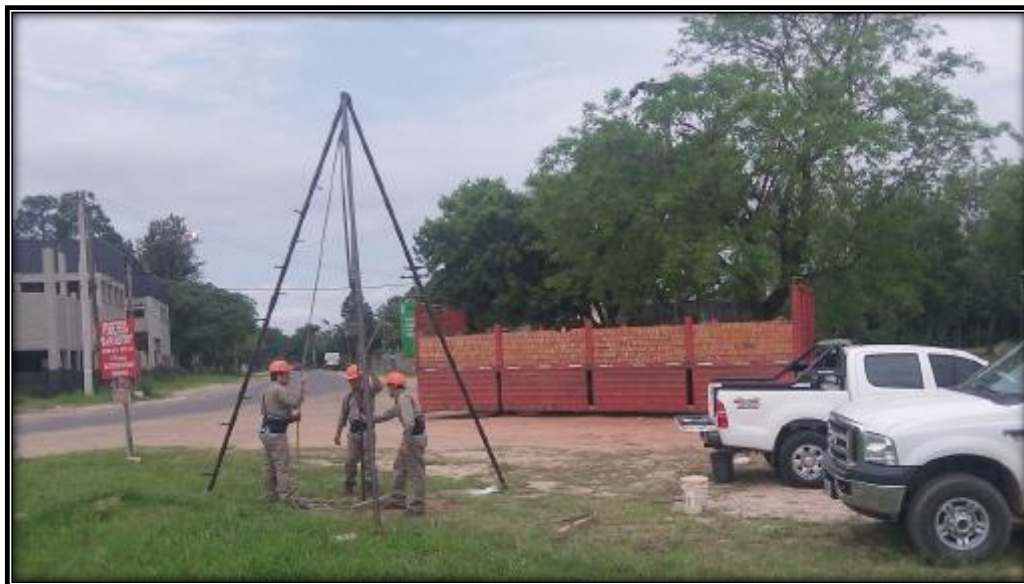
Figura 21. Extracción de la muestra P1 (Fuente: Informe del estudio de suelo realizado por SIGMA SA, 2016)
