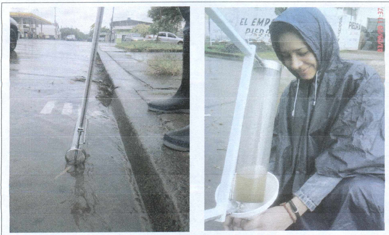
Figura 4.9. Recolección de Muestras mediante captador DH3
