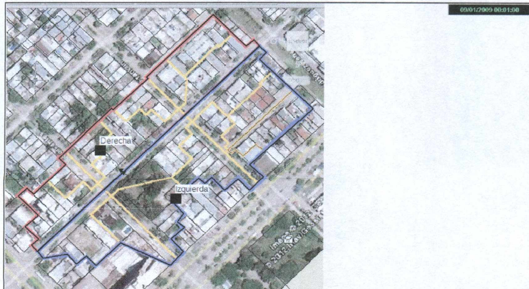
Figura 4.17. Modelo utilizado para analizar la microcuenca de la calle San Lorenzo
