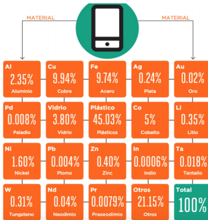
Figura N° 3: Composición de una pantalla inteligente o un monitor complejo. Fuente: https://www.gsma.com/
