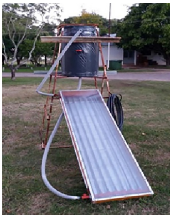
Figura 4.11. Calefón solar construido por los integrantes del GIEMA-FaCENA
