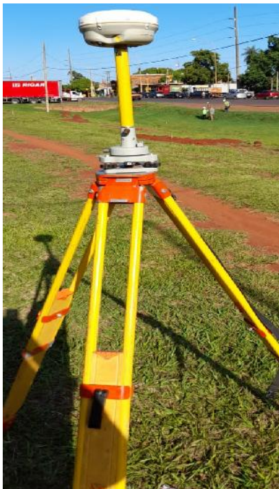
Fotografía N° 1 y 2 - Trimble R4 GNSS – Receptores Base y Móvil. Fuente: Propia.
