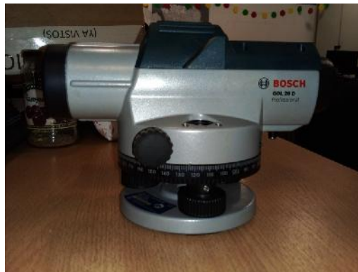
Fotografía N°3 - "Nivel Óptico - BOSCH GOL 26 D" – Fuente: Propia.
