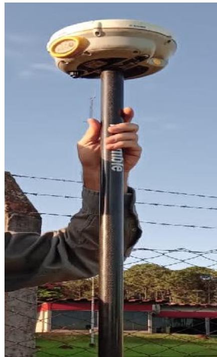
Fotografía N° 1 y 2 - Trimble R4 GNSS – Receptores Base y Móvil. Fuente: Propia.
