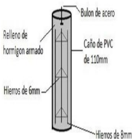
Imagen N°6: Estructura del mojón de hormigón.
