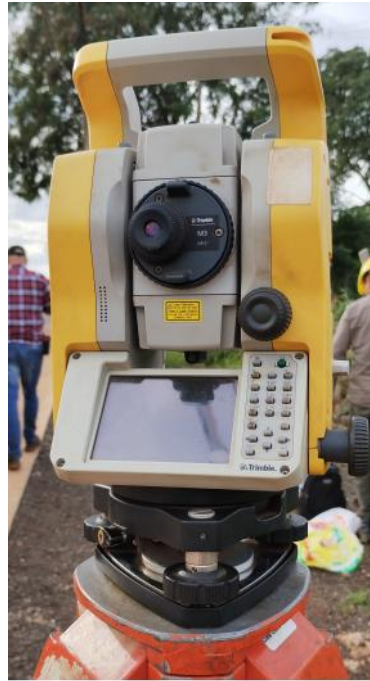
Fotografía N° 5 y Fotografía N°6 – “Estación Total Trimble M3 y Prisma” – Fuente: Propia.
