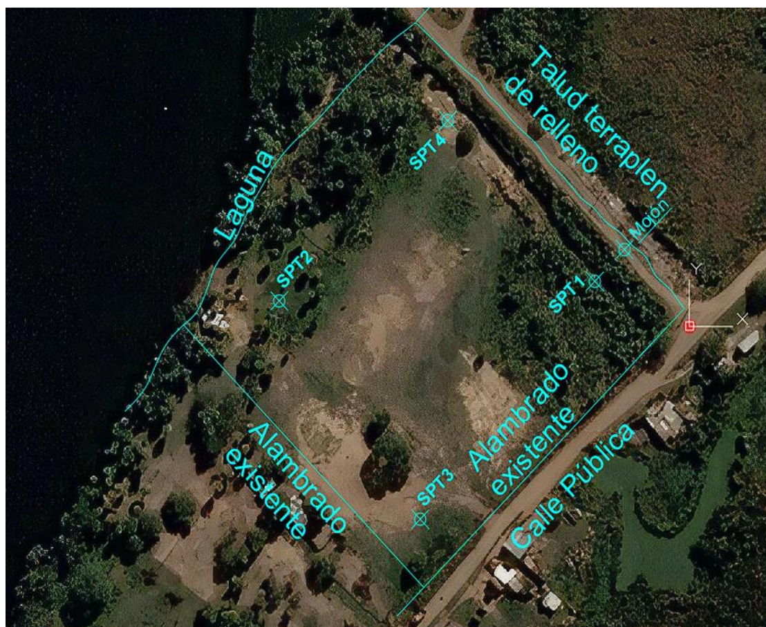
Fig. 16. Ubicación de las muestras tomadas para el estudio geotécnico (Fuente: Elaboración propia).
