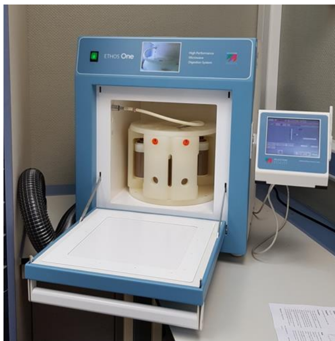
Figura 3.4. Horno de digestión de microondas de alto rendimiento (Milestone, modelo Ethos One)
