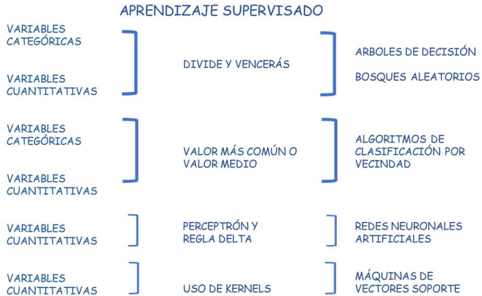
Figura 2.1. Métodos de Aprendizaje Supervisados, según el tipo de variables a los que se aplican y principales características
