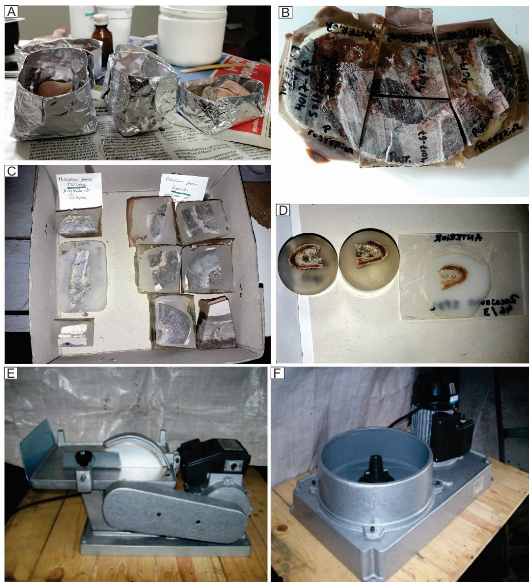
Fig. 21. Obtención de las secciones delgadas. Se ilustran algunos de los procedimientos más importantes así como parte del equipamiento utilizado. A) contenedores de aluminio. B) muestras incluidas en la resina consolidada (taco). C) muestras con una de sus caras pulidas con desbastadora automática. D) taco y sección delgada obtenida. E-F) equipo perteneciente al MPCA (fotos extraídas de Navarro et al., 2018). En E) se visualiza la sierra de precisión con disco diamantado y en F) la desbastadora automática.
