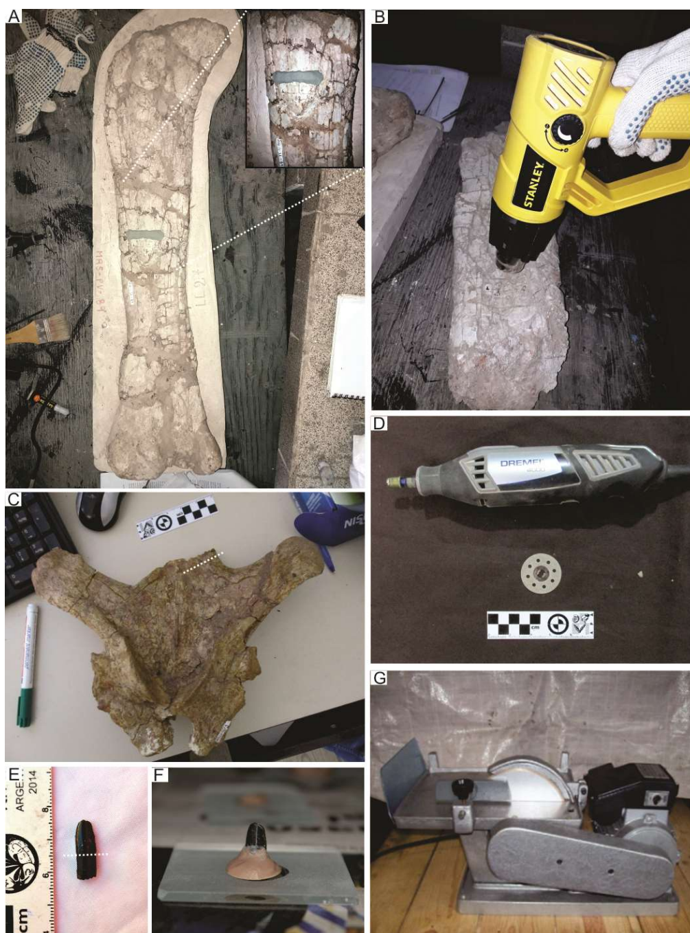
Figura 18. Obtención de la muestra. A) el primer paso consiste en rotular con marcador indeleble el margen lateral o medial y el extremo proximal para orientar la muestra, en este caso un fémur. B) para aquellos materiales que presentaron fracturas naturales se utilizó una pistola de calor para extraer un fragmento de hueso. C-D) las láminas neurales de las vértebras (C) fueron cortadas con minitorno Dremel 4000 (D). La línea punteada en (C) indica la zona de corte. E-F-G) las coronas dentales (E) fueron cubiertas con masilla epoxi (F) y luego cortadas con una sierra de precisión (G). La línea punteada en (E) indica la zona de corte.
