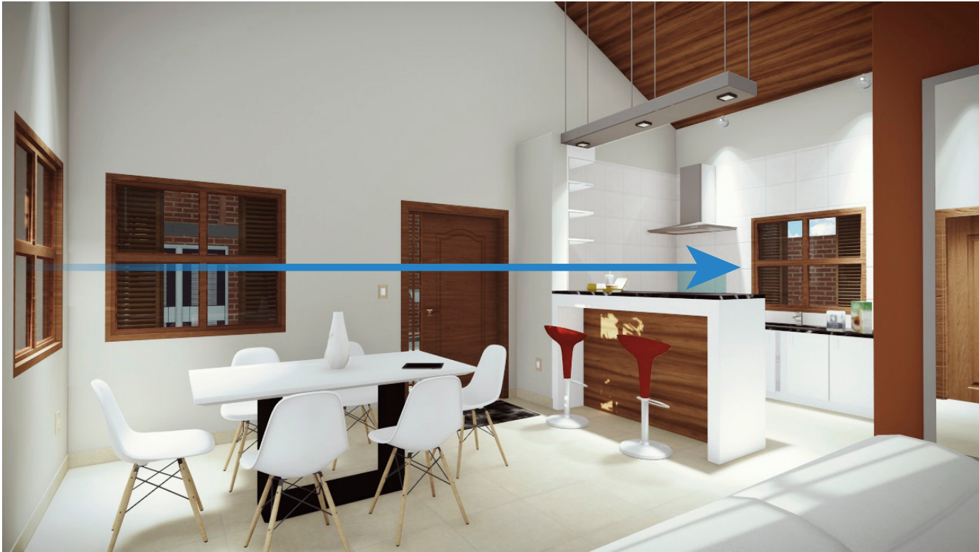
Ventilación cruzada noreste - suroeste en sector principal de la vivienda
