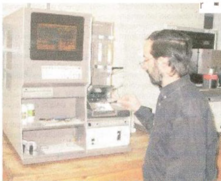
Equipo LECa para determinación de hidrógeno en muestras metálicas de alto punto de fusión
